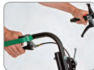
Einfachste Bedienung: linker Hebel -> rückwärts, rechter Hebel -> vorwärts. BC 2600 HHEU. Handschutz serienmäßig
