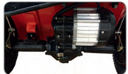
Großer Elektromotor und gusseiserne Achse mit eingebautem Differential.
