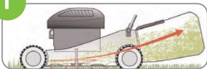
**Fangmäher:** Entfernen Sie den Seitenauswurf, ein großräumiger Grasfangsack fängt den Grasschnitt auf.
