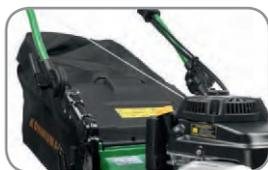
Vibrationsgedämpfter Holm für noch mehr Bedienerkomfort.
