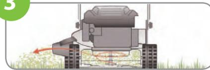
**Seitenauswurf:** Auch für besonders schwere Bedingungen. Nehmen Sie den Grasfangsack ab und stecken den Mulchkeil auf. Dann öffnen Sie die Seitenabdeckung und montieren den Seitenauswurf.
