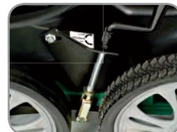
Stufenlose Höheneinstellung über Spindel.
