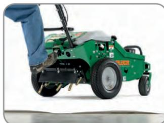
Einfaches Ausheben der Spoons per Fußraste
