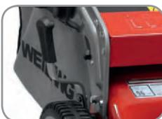
Ein bedienungsfreundlicher Hebel sorgt für eine komfortable und angenehme Schnitthöhenverstellung.
