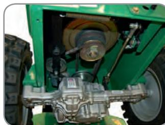
Tuff Torq® Hydrostat; eigentlich für den Antrieb von großen Aufsitzmähern geeignet. BC 2600 HHEU
