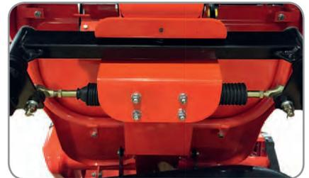
Kugelkopflenkung für präzise und spielfreie Steuerung der Maschine.
