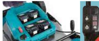
Akku-Box für vier Akkus, die mittels Schalter paarweise ausgewählt werden können
